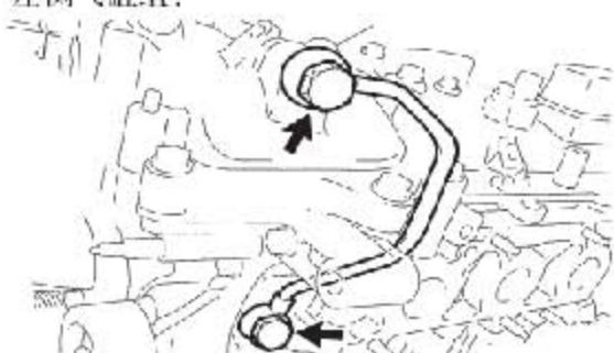
C). 检查并确认机油控制阀滤清器和机油管没有阻塞。
