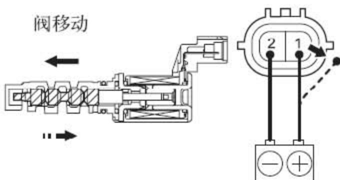
D). 重新安装排气凸轮轴正时机油控制阀总成。
