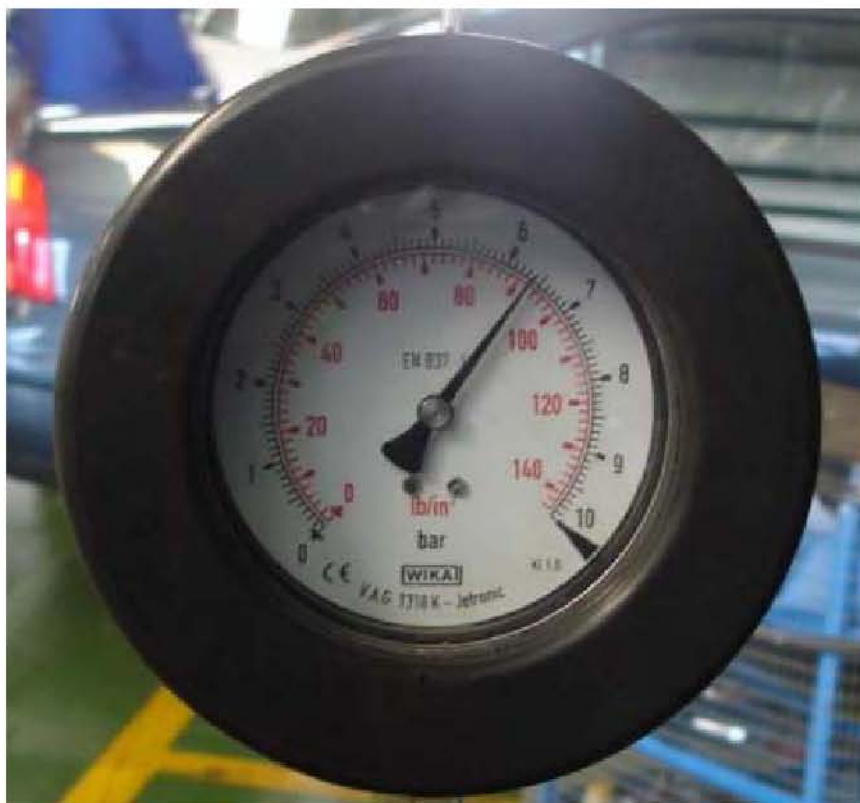
图 6 熄火后低压侧燃油压力 6.4bar，正常
