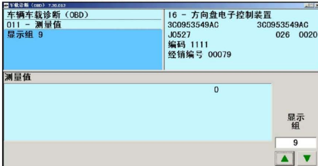
图 4 多功能按钮信息没有传递到转向柱电子装置控制单元
