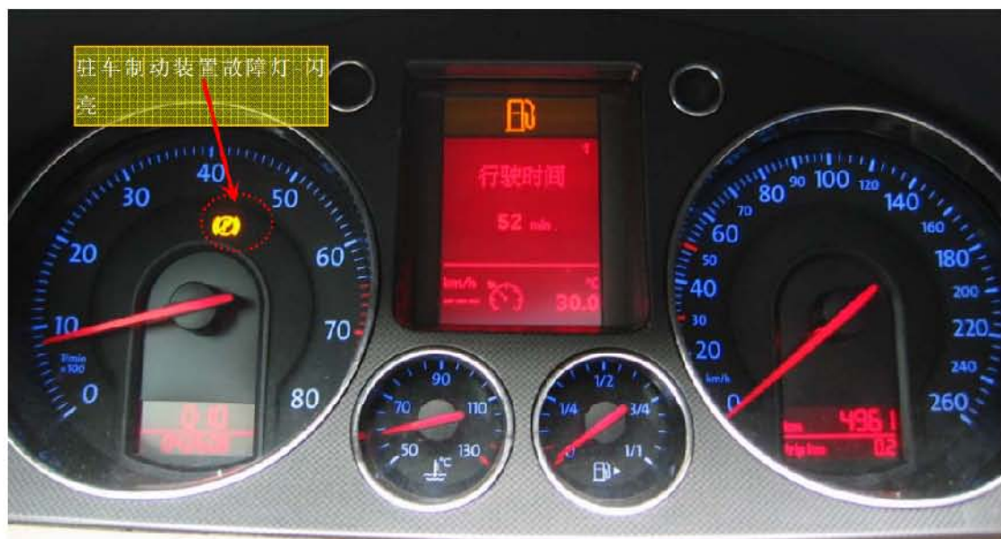
图 1. 迈腾仪表上的驻车制动装置故障灯闪烁
