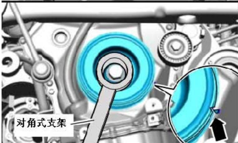
6). 沿(下图箭头所示)方向按压机油泵的链条张紧器，并用定位销锁止。
