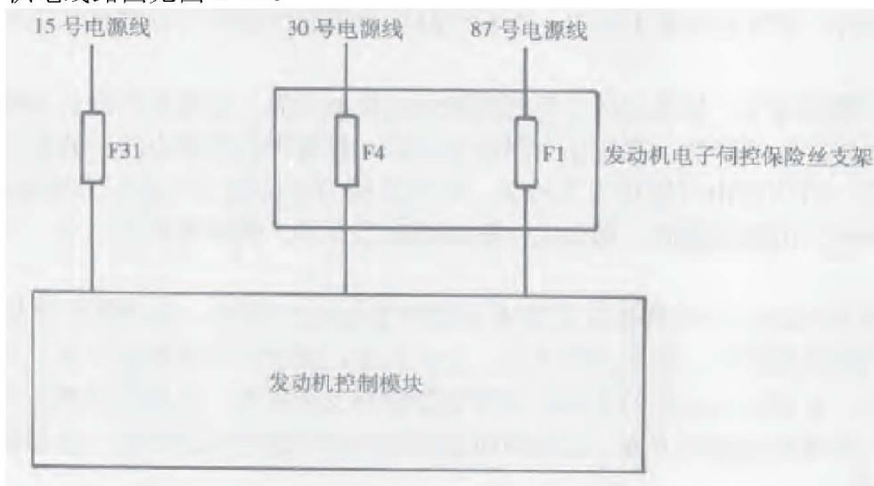
图 I-11 发动机供电线路图
