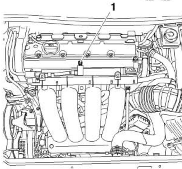
2). 将工具[2]连接在燃油分配器的释压阀(1)上，并将汽油收集在一个容器里。
