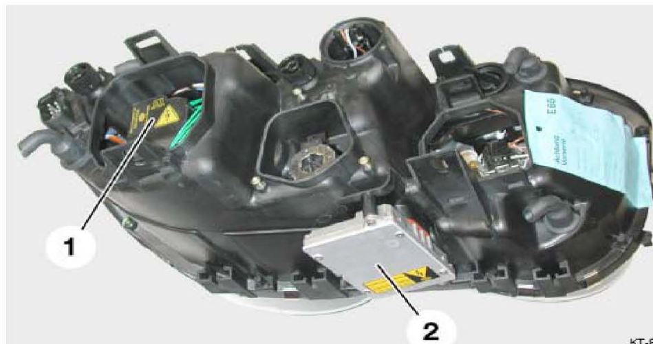
图 10: 带氙气灯灯泡和控制单元的大灯
