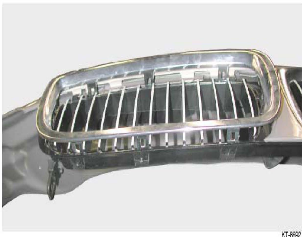
图 7：水箱面罩，由两部分组成
