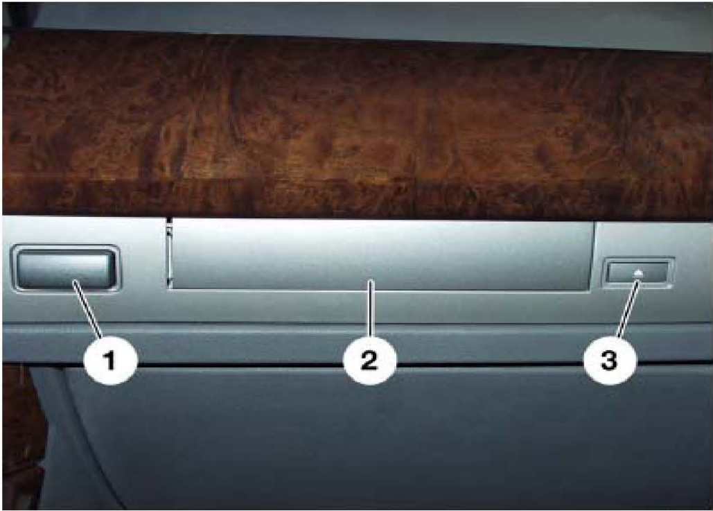
图 24: CD 光盘转换匣在仪表板底座上的安装位置
