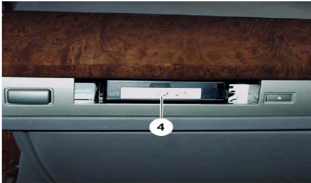
图 25: 用于推入 CD 光盘匣的格层
