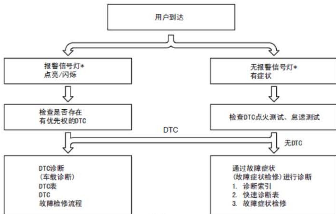
\*: 故障指示灯 (MIL), 发电机报警信号灯, 安全信号灯
