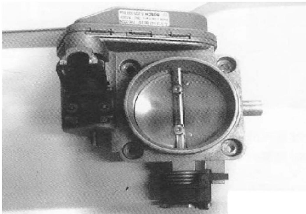
电子节气门总共有两个节气门电位计，分别为 R1 与 R2，它们用来监测经由马达驱动后，实际节气门的角度。
