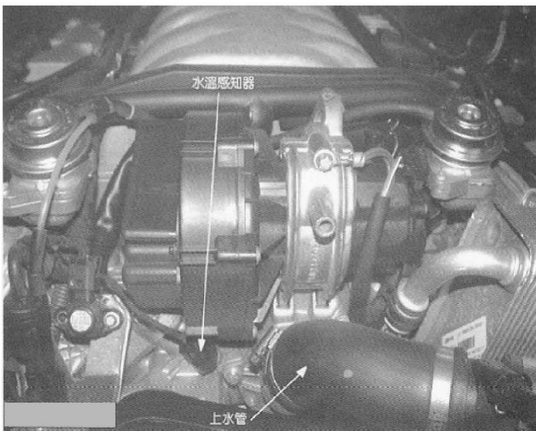
传感器安装在发动机的水路上，它的内部结构采用负温度系数的热敏电阻，这个电阻值会随着水温变化，水温升高时电阻值下降，这个电阻值和电脑板内部的电阻相串联构成了水温的信号端，这个端的开路电压一般在 4.7V—5V 之间。电压随热敏电阻值变化而变化，电阻值越小电压越低，利用这个原理就把冷却水的温度转换成电信号，提供给电脑板，作为控制系统根据发动机温度修正喷油量，点火时刻以及其他控制参数的主要依据。
