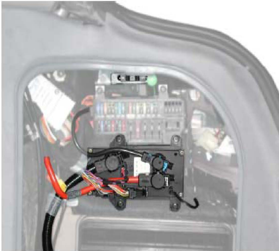
图 5: 供电模块安装在车尾右侧
