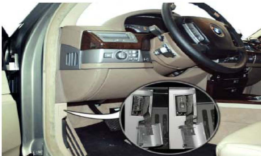
图 27：诊断插座的安装位置
