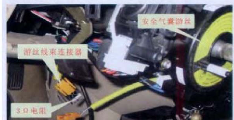
图4 把 3 欧姆的电阻接到游丝导线连接器上进行测试
