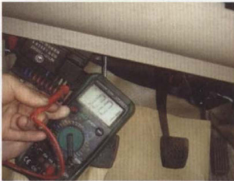
图 2 F12 熔丝的输出断和搭铁短路
