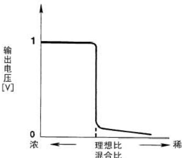
加热型氧传感器 2 位于三元催化剂（歧管）之后，用于监测废气中的氧含量。即使加热型氧传感器 1 的开关特性改变，空燃比仍然可以根据加热型氧传感器 2 发出的信号，控制在化学计量比范围内。该传感器由氧化锆陶瓷制成。氧化锆会产生电压，在氧气充足时大约为 1V，而在含氧稀薄时减小到 0V。在正常情况下，加热型氧传感器 2 是不用于发动机控制操作。
