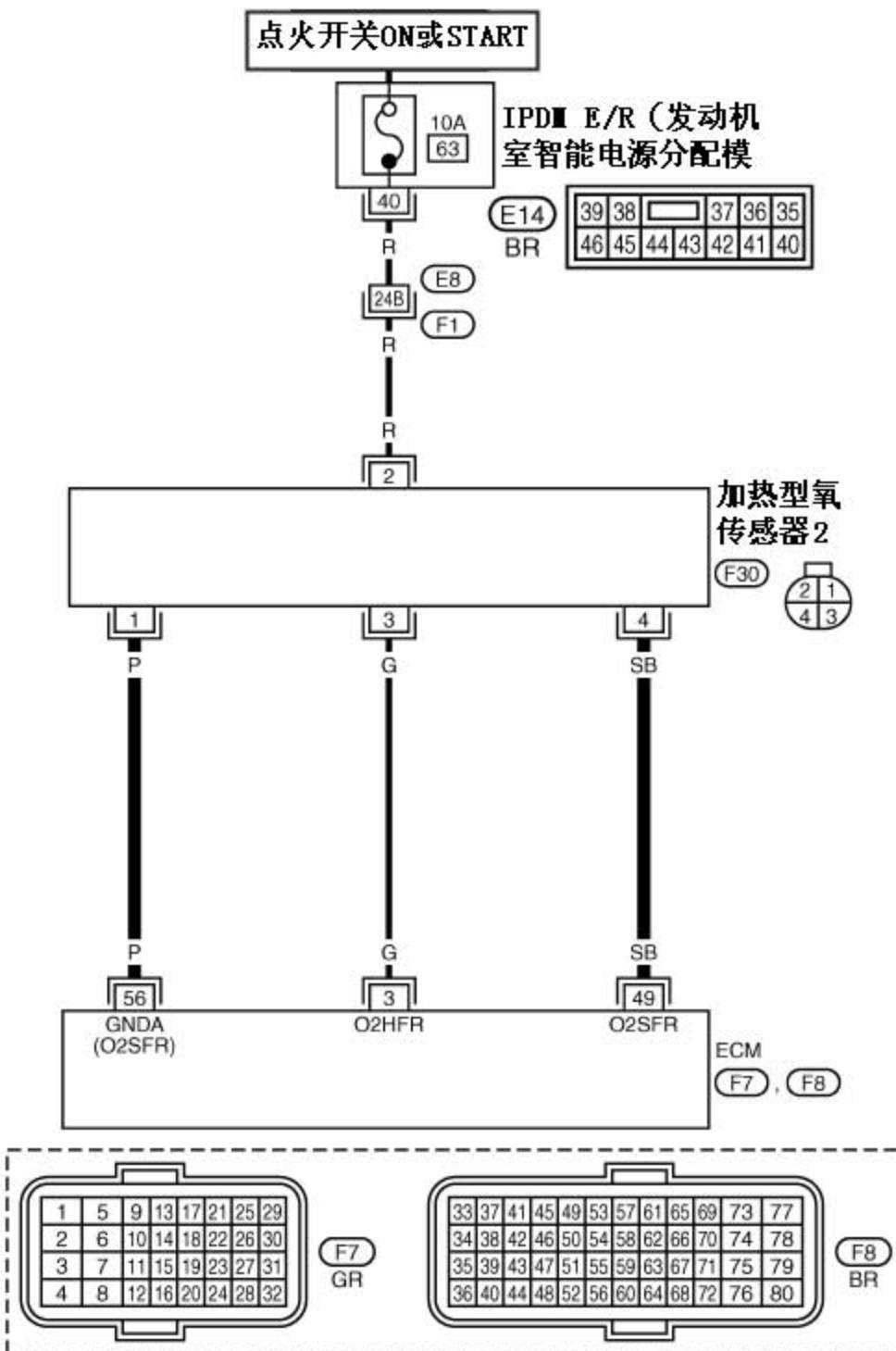
判断标准：在燃油稀和燃油浓状况之间切换时，加热型氧传感器 2 所需要的切换时间要比加热型氧传感器 1 长。经过三元催化之前含氧会导致转换时间加强。为了判断加热型氧传感器 2 是否故障，ECM 需要监视在各种驾驶情况（如缺油时）下，电压是否会异常升高。（如下图）
