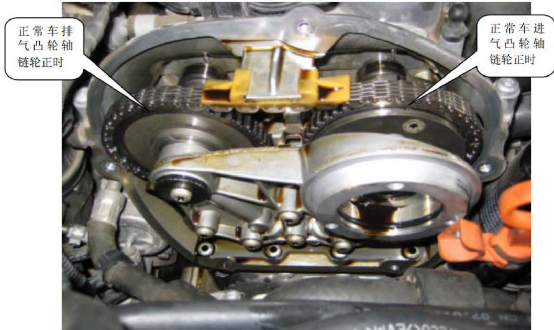
图 2: 正常车进、排气凸轮轴链轮正时
