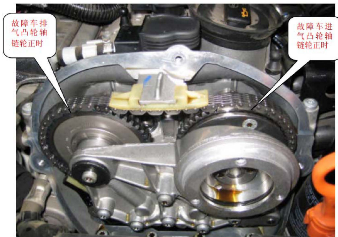
图 1: 故障车进、排气凸轮轴链轮正时
