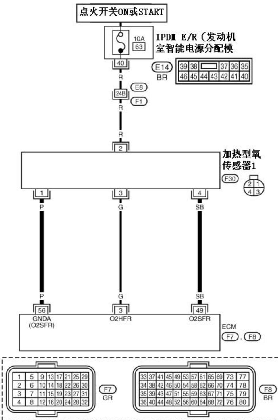
判断标准：诊断加热型氧传感器 1 的信号反馈时间。这个时间由发动机运转（转速和负载）、燃油反馈控制常数，和加热型氧传感器 1 的温度指数来补偿。故障的判断标准基于补偿时间（加热型氧传感器 1 的循环时间指数）是否过长。（如下图）
