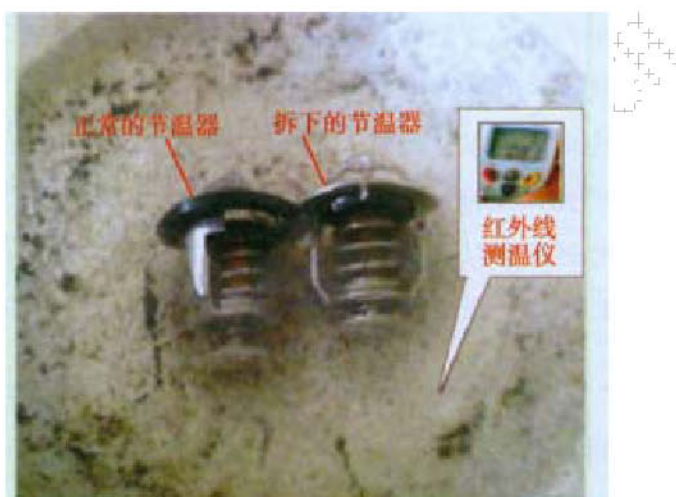
图 5 拆下的节温器与正常的节温器对比测试
