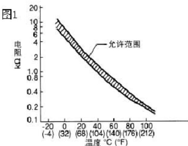
发动机冷却液温度传感器(ECT)用来检测发动机冷却液的温度。此传感器会调整一个来自 ECM 的电压信号。调整后的信号作为发动机冷却液温度测量的输入信号返回给 ECM。该传感器利用了一个对温度改变敏感的热敏电阻。热敏电阻的电阻值会随温度的升高而变小。
