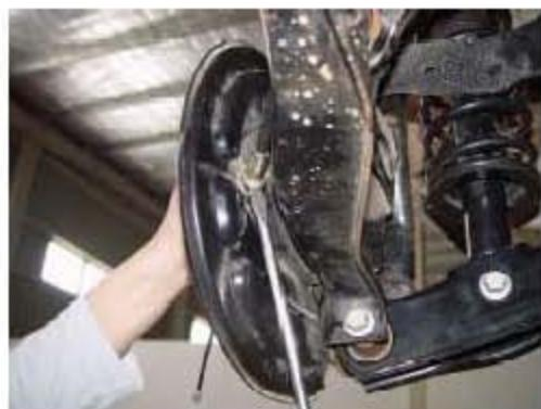
10). 用棘轮扳手和15#套筒卸下图中的螺栓，此时就可将制动拉线拉出了。
