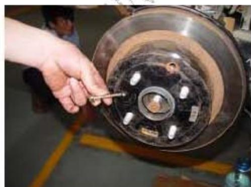
6). 取出后轮制动盘。检测制动盘的厚度，如果低于最小厚度则更换。
