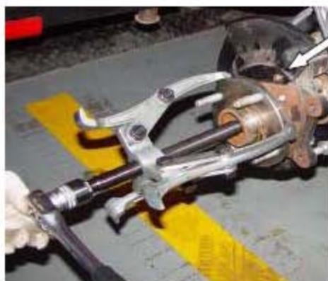
8). 用扭力扳手和18#套筒拆下转向节与控制臂连接螺母。
