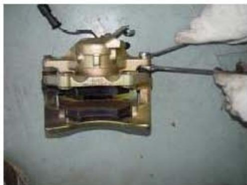
3). 撤开制动钳固定支架，取出制动摩擦片。检测摩擦片的厚度，不满足要求是更换。
