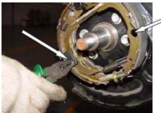
9). 取下手制动蹄片上的回位弹簧和手制动拉线，取下手制动蹄片。
