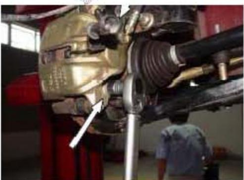
3). 用梅花扳手旋松制动软管与制动钳的连接螺栓。（如果在维修工程中只需要更换摩擦盘的时候，就不需要拆开制动管路）
