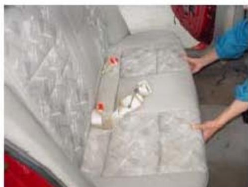
6). 拆开制动拉线支架与地板的紧固螺母，将制动拉线从支架上取出。
