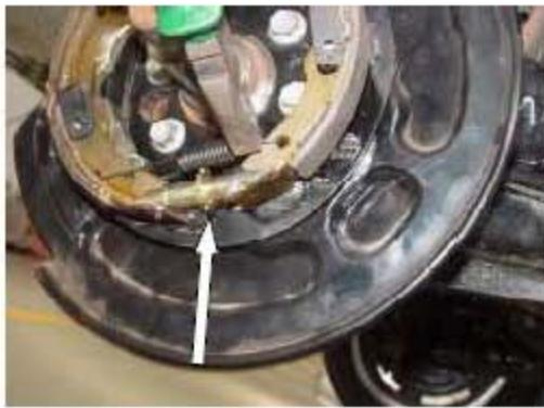
8). 从制动拉臂中取出制动拉线。
