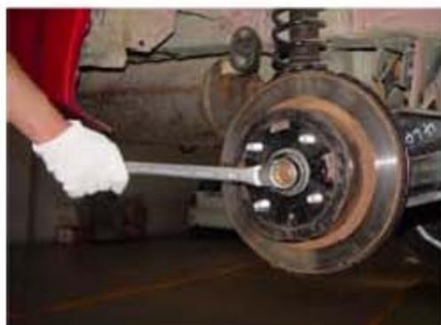
5). 将一个M8的螺栓用8#套筒扳手旋进图示的螺栓孔中，顶出制动盘。
