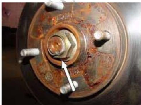
6). 用十字起子旋下制动盘紧固螺钉，取下制动盘。检测制动盘的厚度，如果低于最小厚度则更换。
