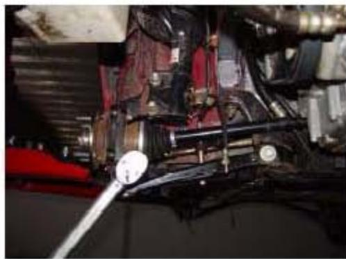
9). 用扭力扳手和17#套筒拆下ABS轮速传感器单元与转向节连接螺栓（三个）。
