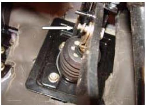
5). 拆下制动踏板支架的四个固定螺栓及制动踏板与车身连接的两个螺栓。
