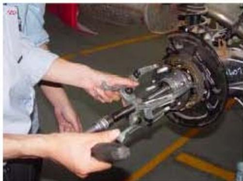
8). 用虎钳旋转手刹制动蹄片上定位销钉，取出限位弹簧座（制动领蹄和制动从蹄上各一个）。
