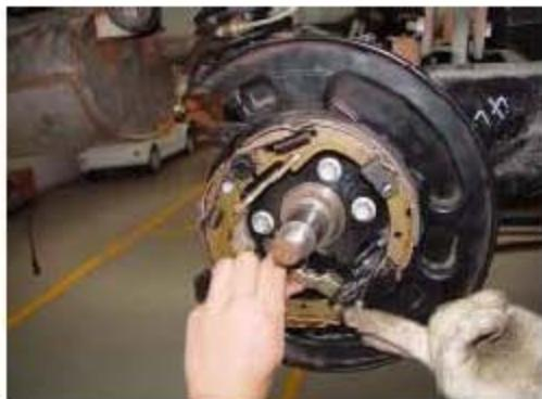
9). 升起汽车，用平口起子从制动底板中撬出制动拉线。
