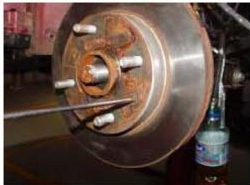
7). 用三脚拉马拉出轮毂。并拆下挡尘板紧固螺栓，拆下挡尘板。
