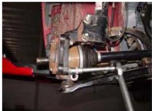
10). 拆开ABS 轮速传感器单元与线束连接插头，并取出ABS 轮速传感器单元。
