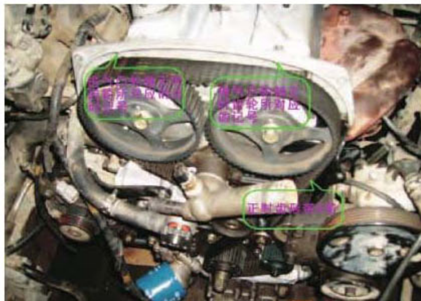
图 3 进、排气凸轮轴正时记号
