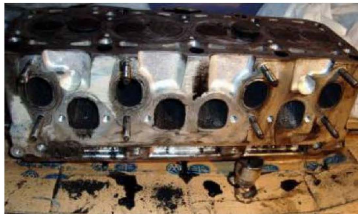
图 2. 进气管道顶积炭
