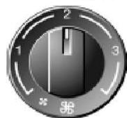
转动旋钮可改变风量的多少。风量越大，空气调节的效果就越大。按 AUTO 按钮可重新打开风量自动功能。
