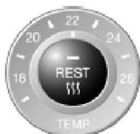
当点火开关关闭后，发动机余热被用来加热车内空间，例如在铁路交叉路口等待通过时。
