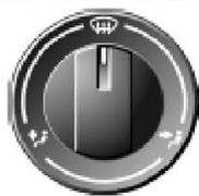
您可以让气流吹向车窗玻璃、吹向上身范围及脚部空间。可设定在任何中间位置。按 AUTO 按钮可重新打开空气自动分配功能。风量自动功能在手动空气分配时仍起作用。
