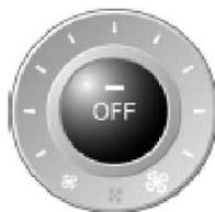
关闭风量、暖风和制冷功能。按压自动空调的任一按钮（REST 按钮除外），可重新打开自动空调。
