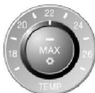
在驾驶员侧和前乘客侧，您可以通过转动旋钮单独设定适合您的温度。已显示的温度值为车内温度的近似值。建议的舒适设置为 22。在任何季节开车后都会尽快达到所选温度并通过调节保持恒定。
