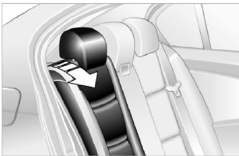
4). 开锁的后部座椅靠背略微自动向前移动。将手指伸入缝隙中抓住并向下翻折。
