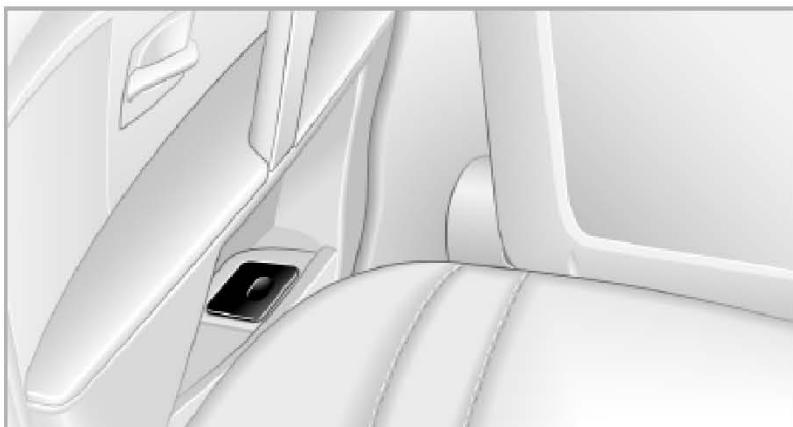
排空：把盖罩完全推开。烟灰缸向上移动即可取下。
