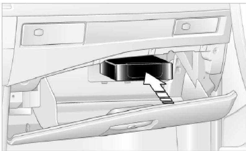
1). 将 CD 光盘匣带箭头一面朝上沿 CD 光盘转换匣方向推进去到固定。
