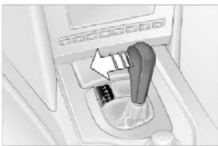
1). 在从 D 切换到 M/S 时运动模式程序被激活，并在档位显示器上显示 DS。如果追求动力型驾驶风格，建议选择这个位置。
