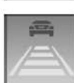
系统要求您通过制动和在必要时绕行进行干预。显示 2 以红色闪烁。主动车速控制不能重新自动建立与前面行驶的车辆的距离。
