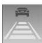
在系统识别到需要由驾驶员进行制动支持的情况下，为了得到转向助力，组合仪表中的显示器 2 以红色闪烁。该显示不能解除驾驶员使预设车速和行驶方式与交通状况相匹配的责任。
