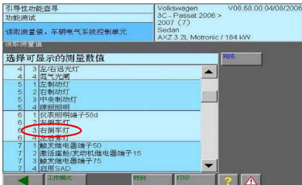
图 5 检查右后倒车灯监控情况
