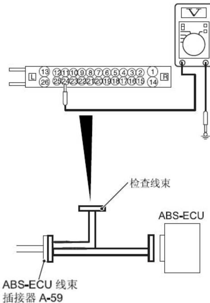
5). 插接器检查: ABS-ECU 插接器 A-59 的电阻、中间插接器 C-125、轮速传感器<左后>插接器 D-113
