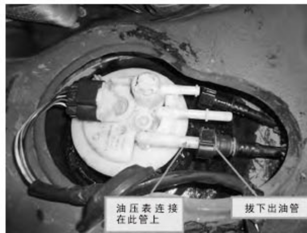
图2 检测油泵的泵油压力
