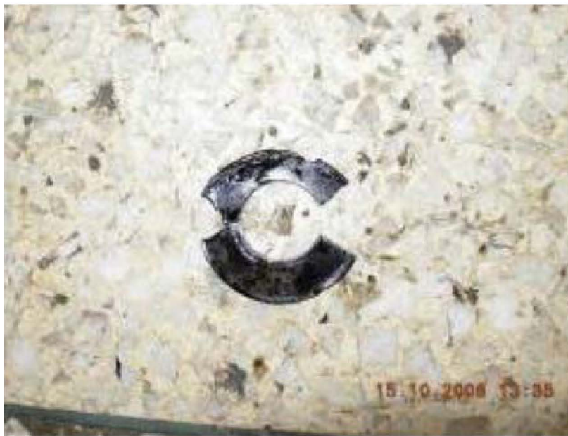
图 2 调节垫片断裂
