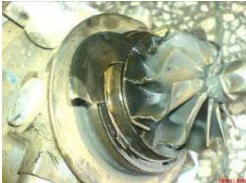
图 1 废气侧涡轮轴卡死
