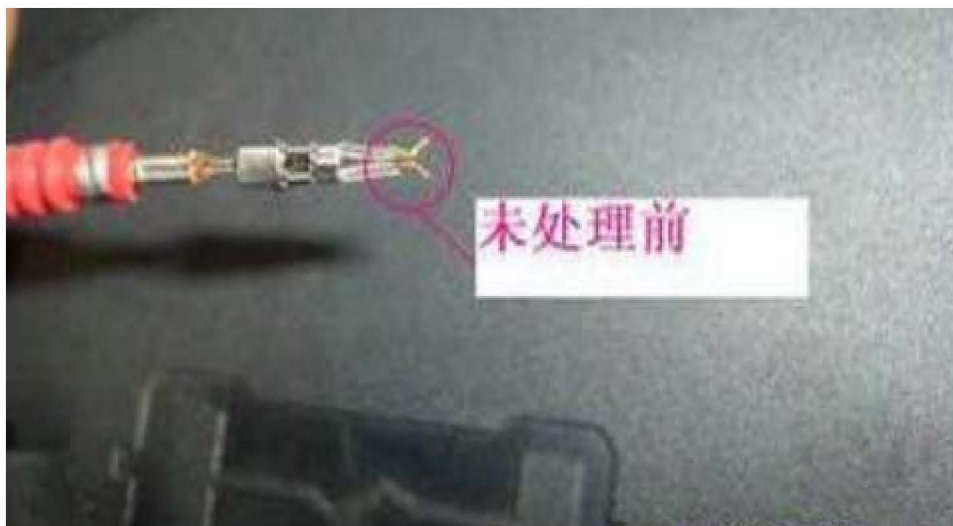
图 5 空气流量计线束侧接口的线插头
