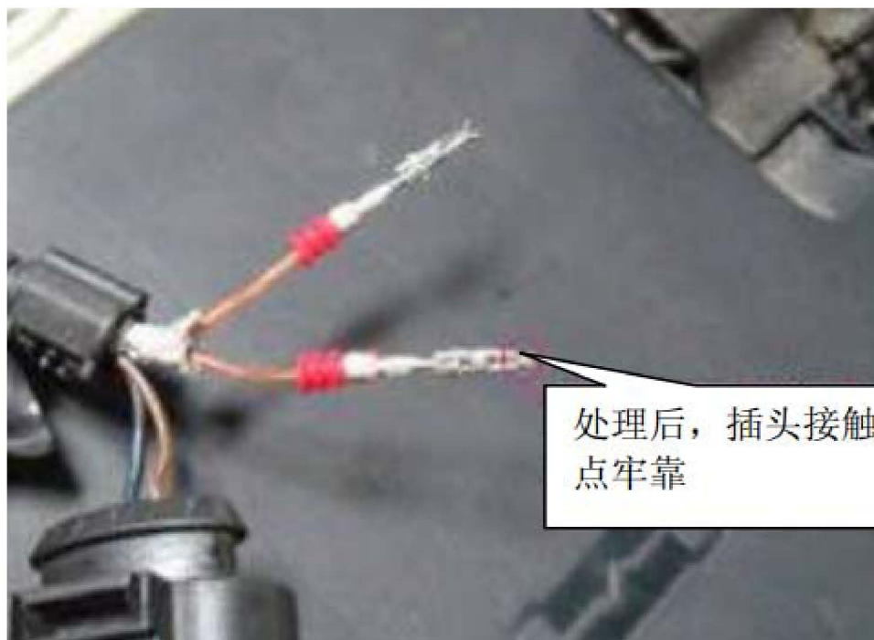
图 7 处理后的线束插头
