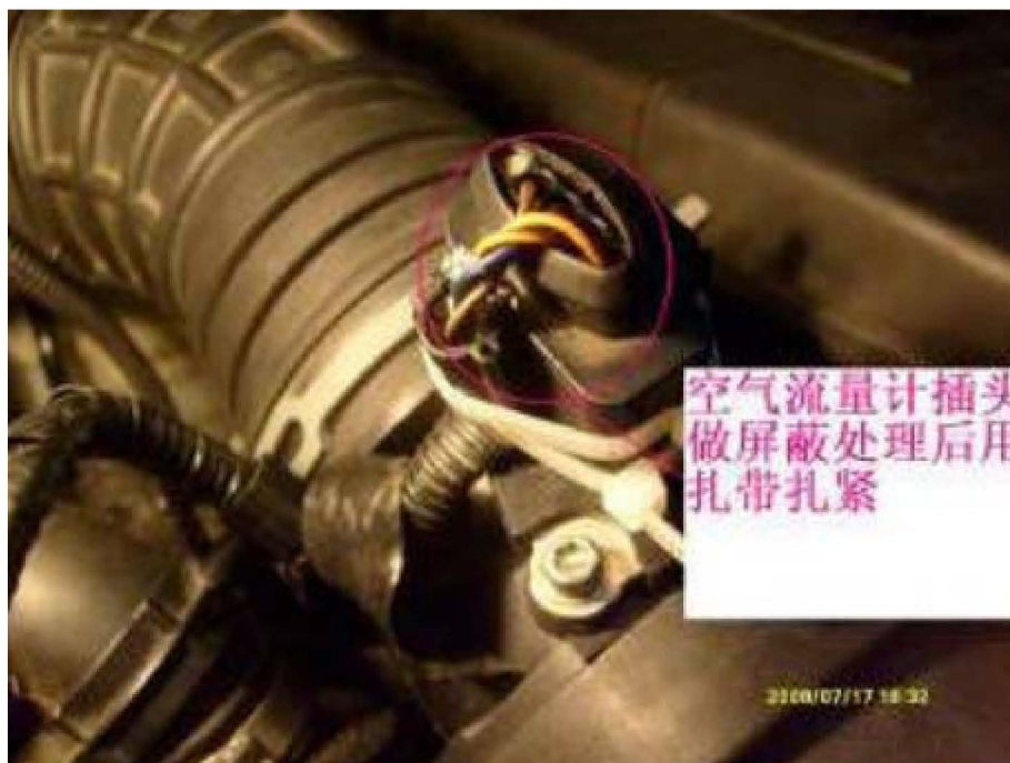
图 4 处理空气流量计插头
