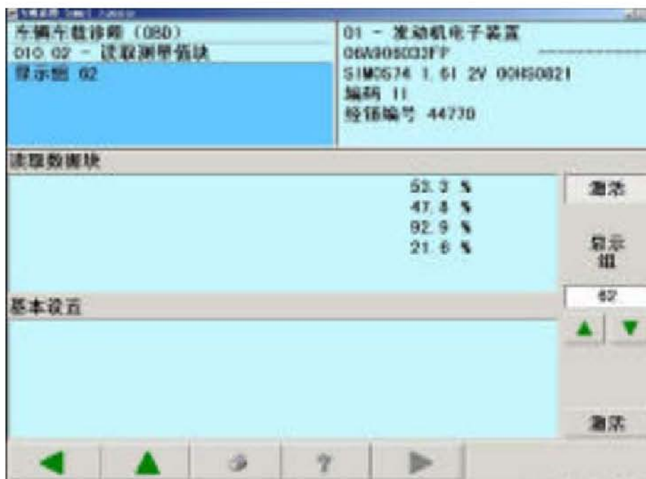
图 6 发动机工作不正常时第 62 组数据流（高负荷数据）
