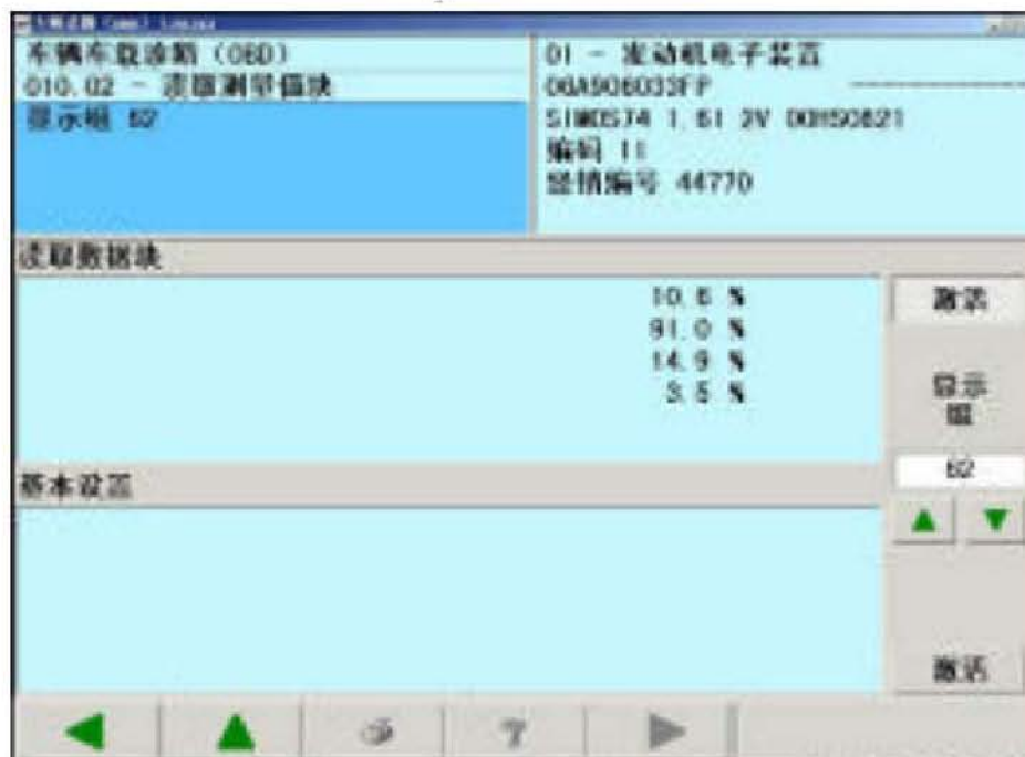
图 5 发动机工作正常时第 62 组数据流
