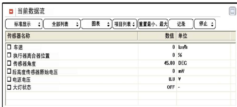
C). 在 AHLS 输出上进行功能测试，选择“执行器测试”。
