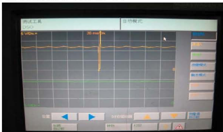
图 1 故障车喷油嘴喷油曲线
