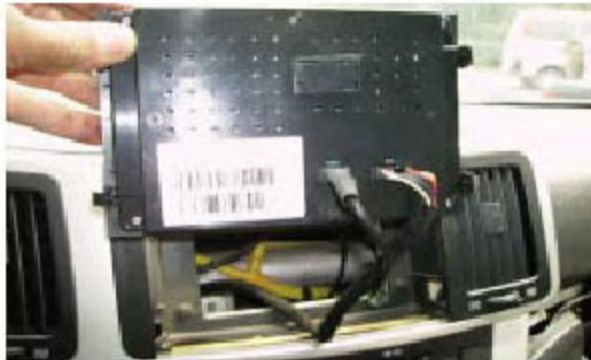
图4 液晶显示器背面及其连接线路
