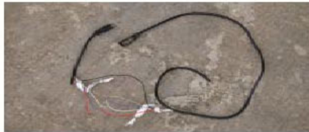
图6 尾门内折断的通讯数据信号线
