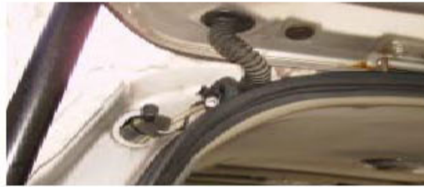
图5 影像数据线尾门插接器
