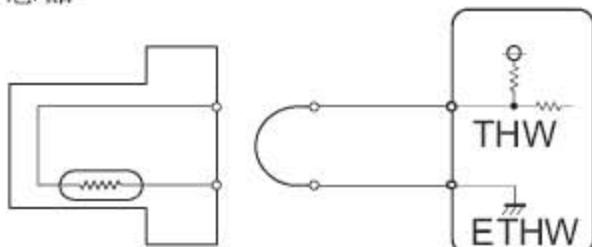
B). 将线束侧的发动机冷却液温度传感器连接器的端子1和2连接起来。
