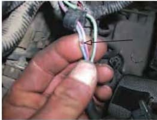
图2. 点火线圈线束短路处
