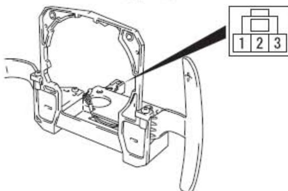
c). 检查方向盘换档 (Paddle Shift) 开关连接器端子之间的导通性。
