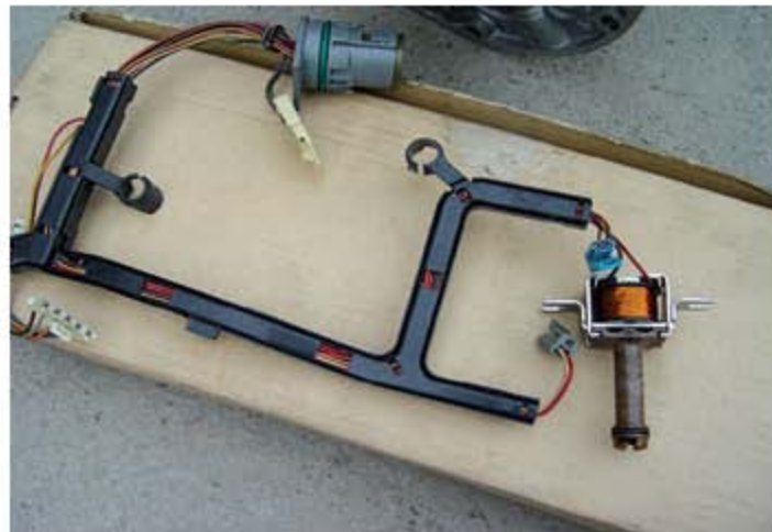
图2 4L60E型变速器锁止电磁阀
