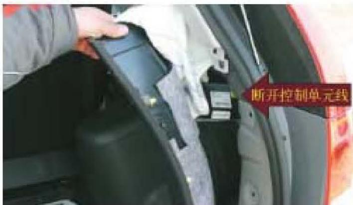
图1 在图示位置断开控制单元连线
