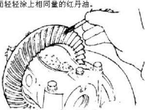
2).在差速器壳和差速器盖之间插入一个铜杆,用手旋转结合法兰(一次在正常方向,然 后在相反方向),同时给传动齿轮加载使得传动齿轮上有一定的扭矩(大约 25-30kg. cm).
