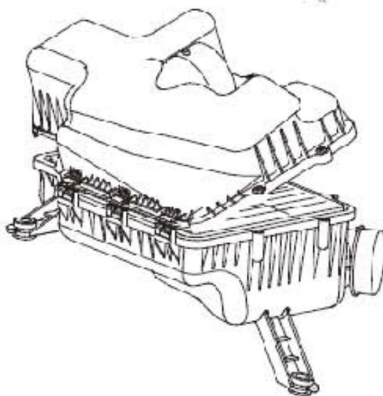
c). 空气滤清器与右前挡泥板上处3个紧固六角头螺栓、弹簧垫圈和平垫圈组合件的拧紧力矩为： $4 \pm 2 \text{N} \cdot \text{m}$ 。
