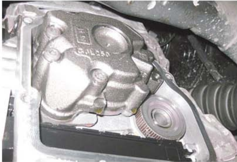
(图 5) 注意输出轴 2 传感器支架的位置
