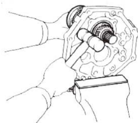
A). 一边拉输出轴, 一边敲进中联板, 将输出轴装入 中联板。
