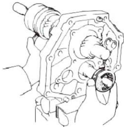
A). 将止动环安装在中间轴后轴承上。
