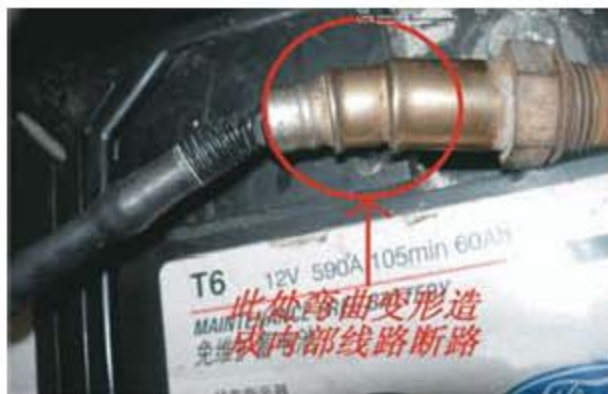
图2 氧传感器损坏处
