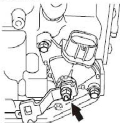
B). 使用螺丝刀松开锁止板，并拆卸锁止螺母和锁止板。
