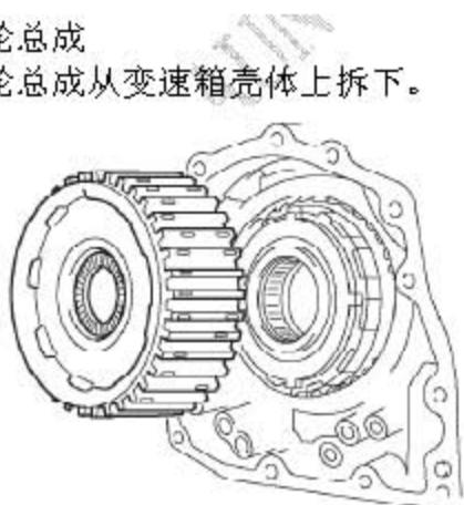
B). 将止推轴承从后行星太阳轮上拆下。
