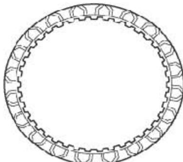
7). 检查 1 档和倒档制动器回位弹簧分总成
