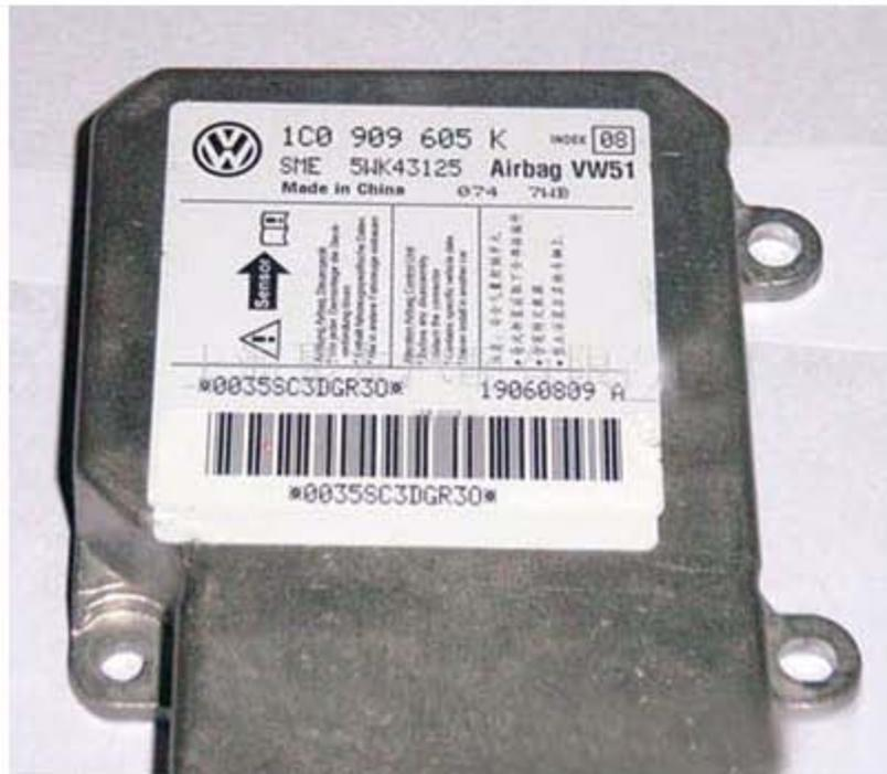
2). 对于第 1 个故障码, 笔者怀疑是控制单元型号与原车控制单元(附图)型号不一致造成的, 可原车控制单元不在无法进行比较, 只得另外找了一个相同配置的轿车, 用诊断仪调取两车气囊控制单元的有关参数, 包括配件号、版本号、控制单元编码等, 经比较发现两个控制单元的配件号、版本号一致, 但是控制单元编码不同, 一个为 12854, 一个为 12851, 看来故障可能就出在这方面, 于是查找相关资料, 原来帕萨特领域轿车气囊系统根据车型配置不同, 气囊控制单元的编码也不相同, 配置手动变速器、普通转向盘及主副气囊的车型, 控制单元编码为 12854。而配置手自一体变速器多功能转向盘、主副气囊、前排乘客侧气囊及后排燃爆式安全带车型的控制单元编码为 12851。
