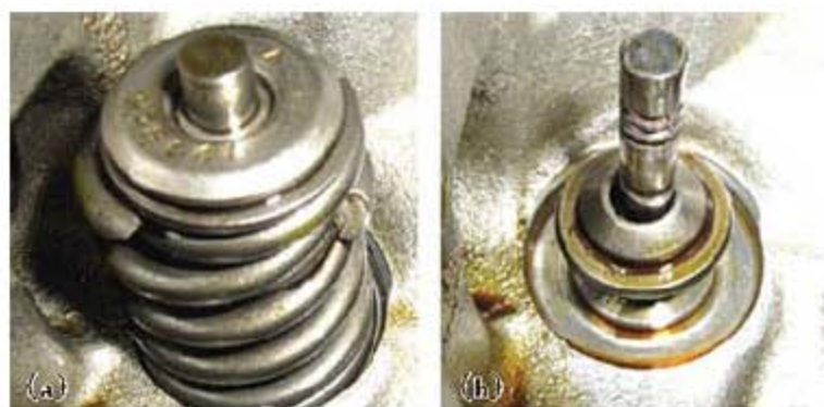
a——气门弹簧断裂 b——多余弹簧座
